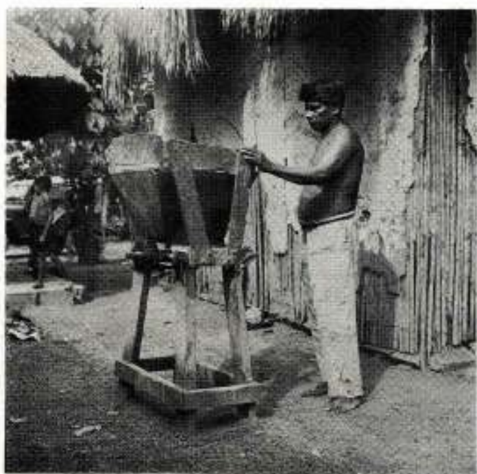
Foto N° 16. Quebradora de corozos de fabricación local. El Quemado, Cereté.
