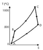
Diagrama del ciclo Brayton en una turbina de gas, en función de la entropía S y la temperatura T.
